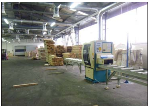
A fűrészelt, szárított lamella további megmunkálásához elkészült a gyalucsarnok légtechnikája. Nem változhat az alapanyag nedvességtartalma
